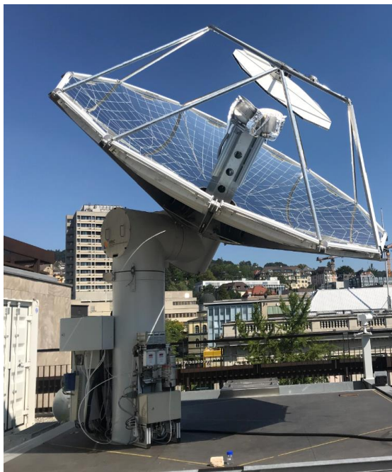
Abbildung 3: StL-Laboranlage auf dem Dach der ETH Zürich. Der Reaktor ist das Gerät im Fokus des Parabolspiegels. Copyright Melanie Heininger
